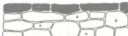
Decksteine satt aufliegend
